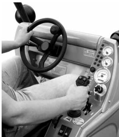
De AVANT 600 serie is voorzien van een hydrostatische aandrijving. De hydropomp in het aandrijfsysteem heeft een variabel debiet dat traploos bepaald wordt door middel van de twee rijpedalen. De rijpedalen werken op een evenredige manier om de rijsnelheid en het beschikbare vermogen aan de aandrijfmotoren te controleren.
