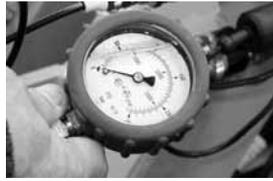
**Rijdruk:** De rijdruk moet aan iedere hydromotor individueel gemeten worden. Er zijn twee overdrukventielen (een voor het vooruit en een voor het achteruit te rijden) met een vaste waarde van 300 bar.
