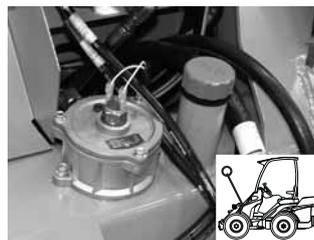
De hydrauliek drukfilter bevindt zich in het achterste gedeelte langs de hydraulische pompen. Wanneer u de filter losschroeft, houd de schroef in de behuizing met een 12 mm inbussleutel en vervang de filter.
