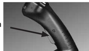
ventiel treedt in werking van zodra de knop op de joystick wordt ingedrukt. Wordt de knop gelost dan schakelt het anti-slip ventiel uit. De werking van het anti-slip ventiel is gekoppeld aan de anti-sper functie.
