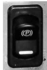
**OPGELET!** Schakel de parkeerrem niet in als de machine in beweging is om beschadigingen aan de remschijven van de voorste rijmotoren te voorkomen. De machine volledig stoppen alvorens de handrem in te schakelen.
