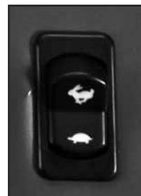
**OPGELET!** Niet van versnelling veranderen wanneer er snel gereden wordt. Eerst de machine stoppen of traag rijden alvorens van versnelling te veranderen. Wees extra voorzichtig wanneer er snel met de machine gereden wordt. Niet met de machine draaien tegen hoge snelheid.
