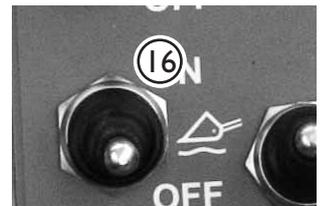
Door het gebruik van de zweefstand kan er lucht in het hydraulisch circuit komen. Na het gebruiken van de zweefstand de laadarm en de snelkoppelplaat tot hun uiterste posities bewegen om het systeem te ontlichten. De zweefstand enkel gebruiken indien nodig.
