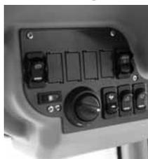
Vanaf 2/2013 is er een paneel in de cabine DLX bovenaan aan de rechterkant, met de volgende knoppen: parkeerrem, A/C aan/uit (635 en 640), ventilatie, hydraulische koppelingsplaat, noodknipperlichten, rijsnelheid schakelaar (640), zwaailamp.
